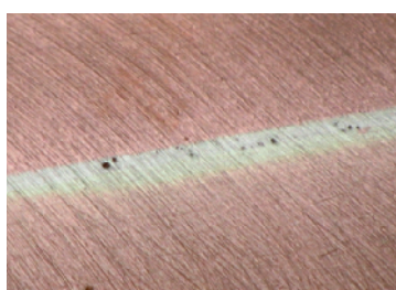
DA EVITARE. Alcuni esempi di difetti in brasatura.
